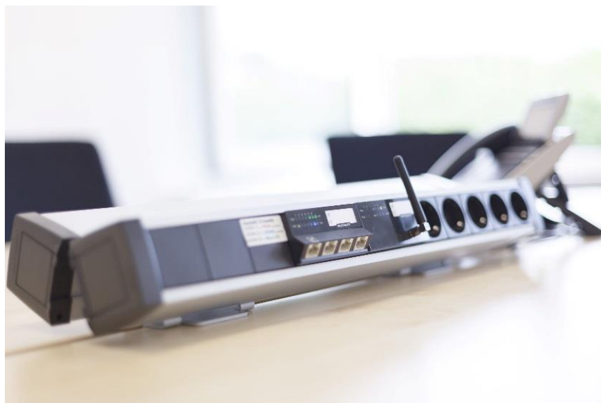
Abb. 5: Installationseinheit mit Micro-Switch und Micro Access Point
