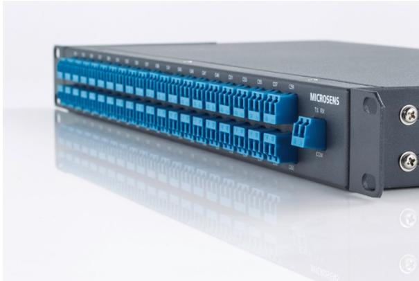
Der passive Filter integriert 40 DWDM Kanäle in einem besonders kompakten 1 HE Gehäuse für 19" Einbau und vereint hierbei Multiplexer und Demultiplexer in einem Gerät. Ein zusätzlicher Filterrahmen wird nicht benötigt. Der kompakte 40 Kanal Filter bietet sich immer dann an, wenn ein großer Endausbau geplant ist und die Modularität der MICROSENS Filterkarten nicht erforderlich ist. Alle Schnittstellen sind mit LC-Steckverbindern ausgestattet. Das Gerät benötigt keinen Stromanschluss.
