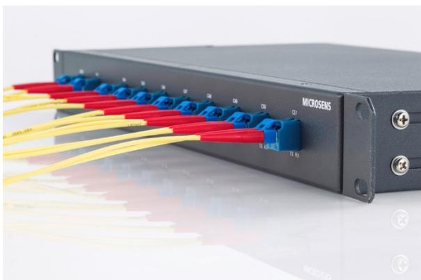
Der 1HE 8 Kanal DWDM Filter deckt den Einstiegsbereich im DWDM Segment ab und stellt insgesamt 8 aufeinanderfolgende ITU Wellenlängen (Kanäle) bereit. Die Einfügedämpfung für Mux und Demux beträgt im Durchschnitt ca. 6 dB und alle Schnittstellen sind mit LC-Steckverbindern ausgestattet. Das Gerät benötigt keinen Stromanschluss.
