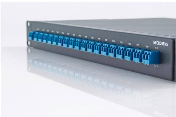
Der 1 HE 18 Kanal MUX/DEMUX CWDM Filter deckt den gesamten CWDM Wellenlängenbereich ab (1270-1610 nm) und ist genau dann vorzusehen, wenn mehr als nur die „oberen“ 8 Wellenlängen für das Netzdesign geplant sind. Die Einfügedämpfung beträgt im Durchschnitt ca. 6 dB und alle Schnittstellen sind mit LC-Steckverbindern ausgestattet. Das Gerät benötigt keinen Stromanschluss.
