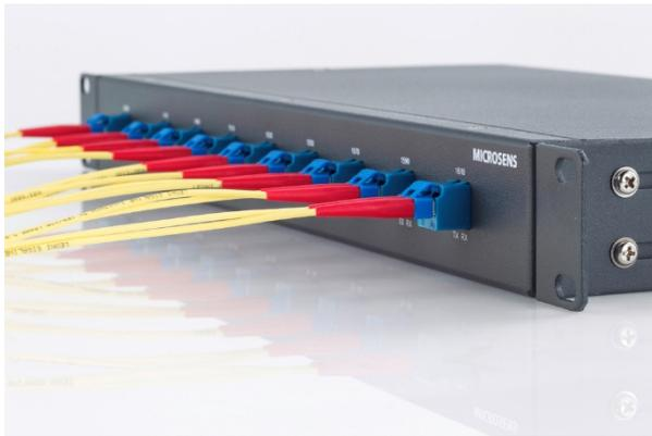
Der 1 HE 8 Kanal MUX/DEMUX CWDM Filter deckt den Wellenlängenbereich von 1470 - 1610 nm ab und enthält Multiplexer/Demultiplexer in einem Gehäuse. Die Einfügedämpfung des 1HE CWDM Filter beträgt im Durchschnitt ca. 4 dB und alle Schnittstellen sind mit LC-Steckverbindern ausgestattet. Das Gerät benötigt keinen Stromanschluss.
