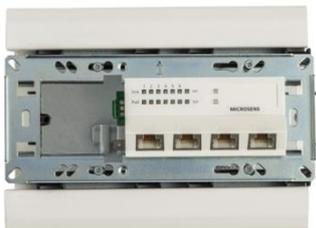
Zunächst wird der Switch wie gewohnt werkzeuglos montiert und in Position gebracht. Ein seitliches Verschieben würde in der dargestellten Situation einen Ausbau ermöglichen.
