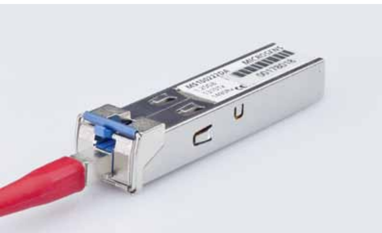
SFPs mit je einer Faser pro Link: BiDi-SFP (links) und Compact-SFP (rechts)
